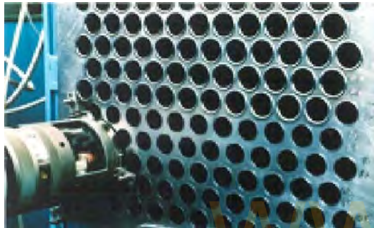
WELDING 5F TUBESHEET.: PLAQUEADO TITANIO TUBES: TITANIO Gr2
